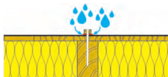
Uszczelnienie kontrłat – wilgoć nie przenika.
