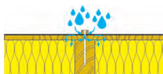
Mocowanie kontrłat bez uszczelnienia.
